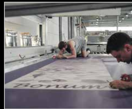
De zeef wordt op de zeefdruktafel gemonteerd en technische instellingen aangebracht.
