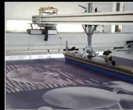
De rakeldruk wordt ingesteld. De glasplaat ligt nu onder de zeef.
